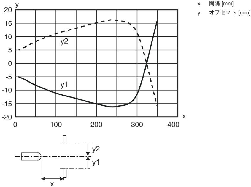
典型的応答挙動 (調整距離 600mm)
