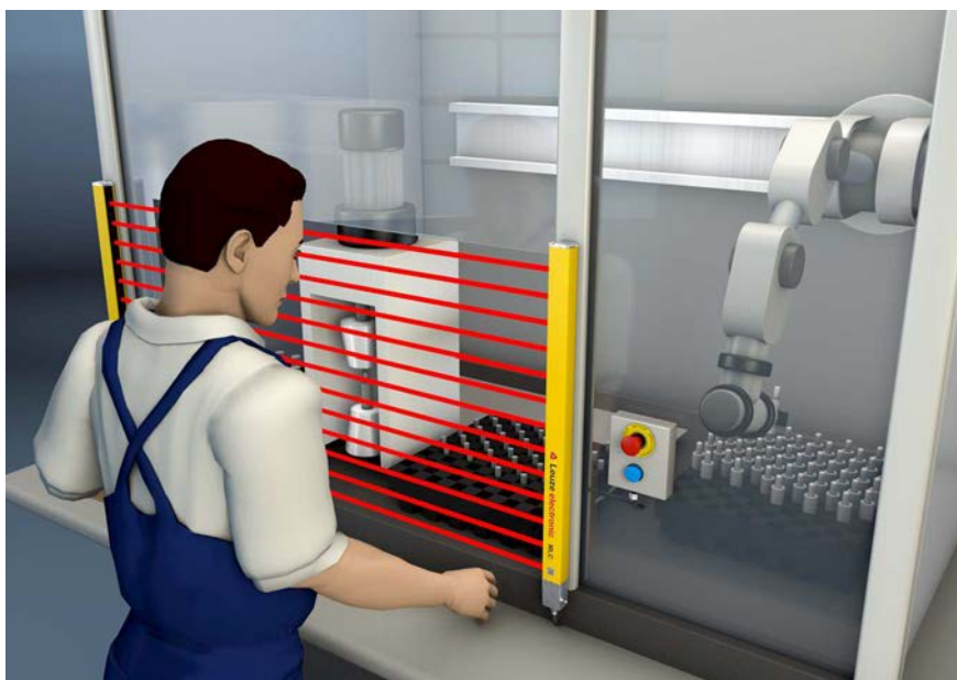
Figura 5.2: Las protecciones de puntos peligrosos protegen en caso de intervención en la zona de peligro, p. ej., en una aplicación de robot pick & place
