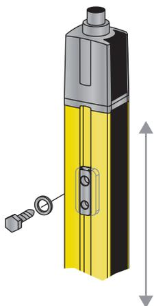
Fig. 6.7: Montage à l'aide d'écrous coulissants BT-NC60
