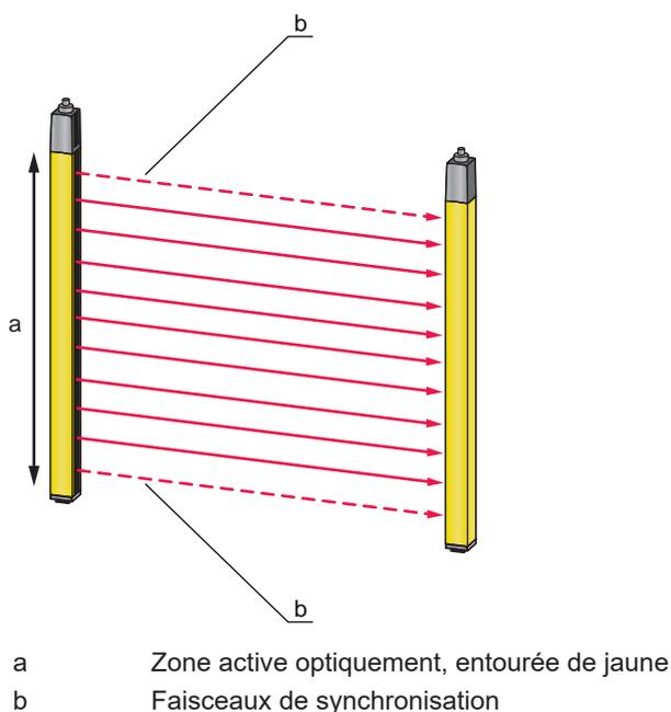
Fig. 3.1: Système émetteur-récepteur
