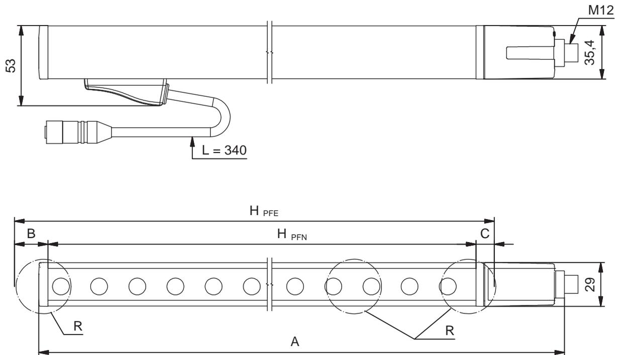
Fig. 14.1: Dimensões do transmissor Host e receptor Host
