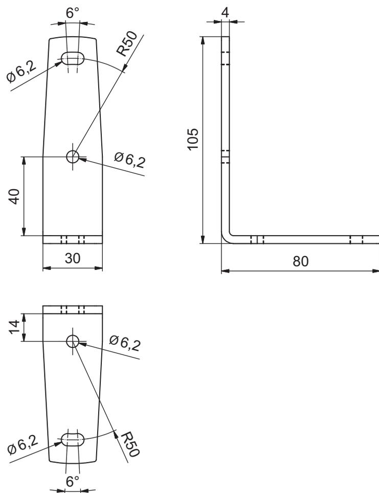
Fig. 14.8: Ângulo de ligação para L-Shape ou U-Shape
