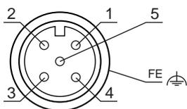
Fig. 7.2: Ocupação dos conectores do receptor
