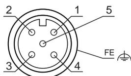
Fig. 7.1: Ocupação dos conectores do transmissor
