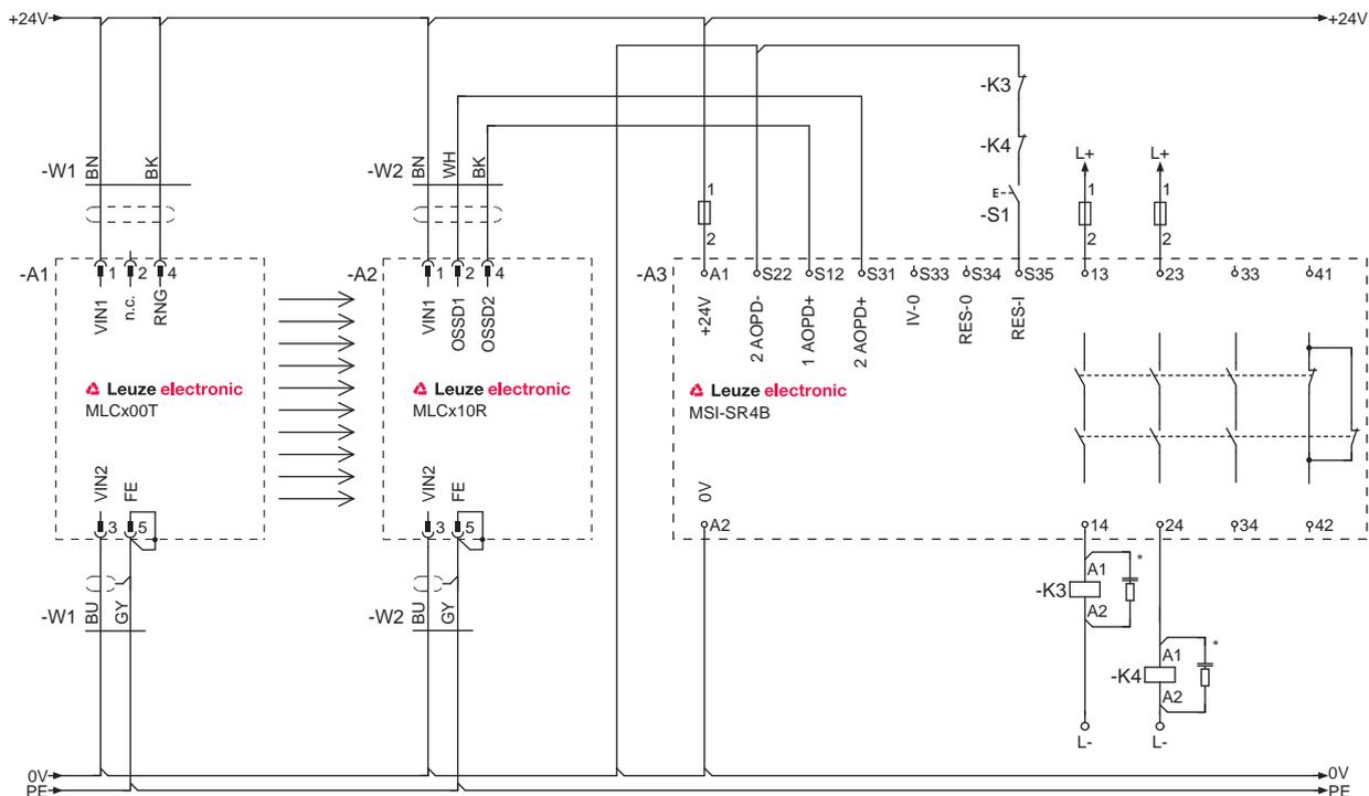
图 7.4: 带后置安全控制器MSI-SR4B的接线示例
