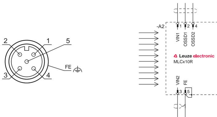
图 7.3: 接收器的插头分配和接线图
