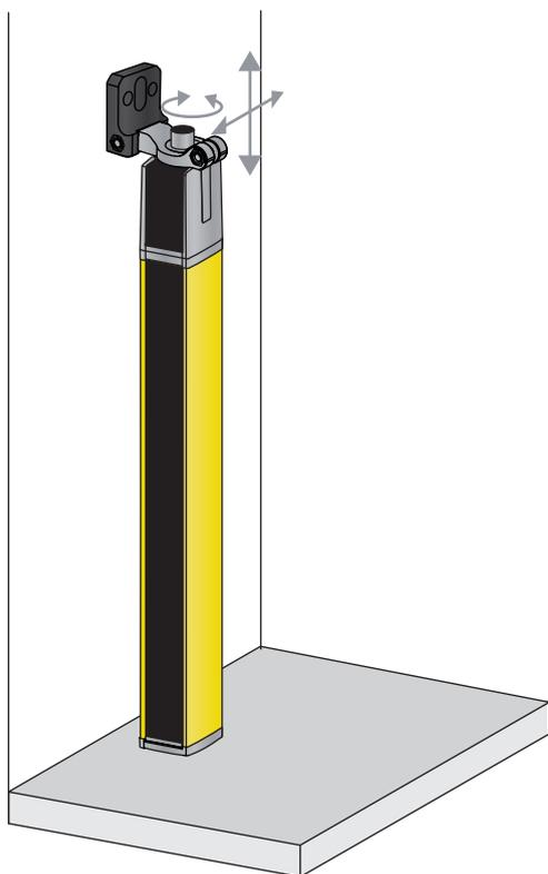
图 6.10: 直接固定在机台上
