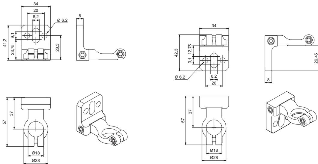
Fig. 14.4: Suporte giratório BT-2HF
