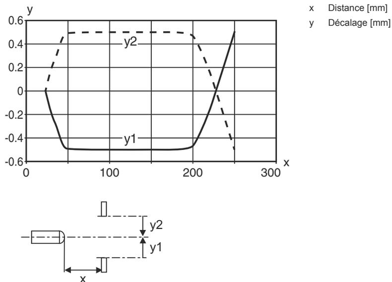
Réaction typ. (distance de réglage 600 mm)
