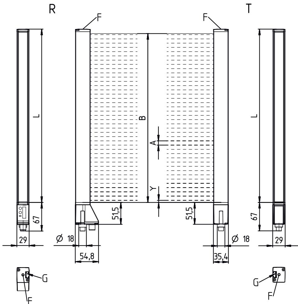
A 光束距离 10 mm      L 型材长度 488 mm
