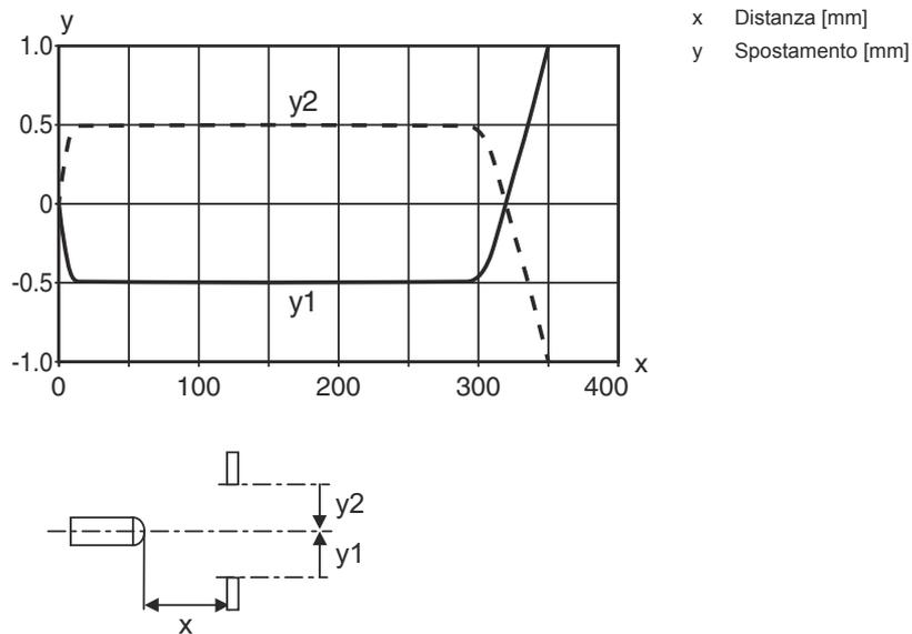
Comportamento di risposta tip. (distanza di regolazione 800 mm)
