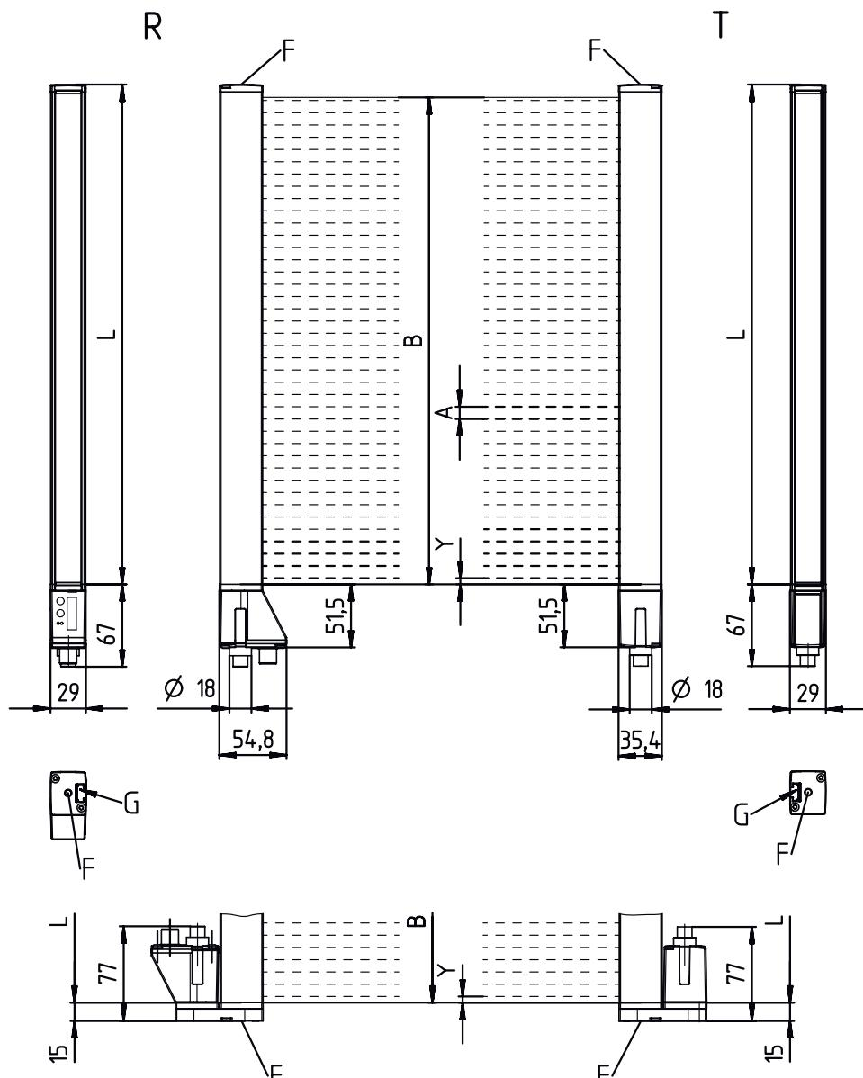
A Intervalle entre les faisceaux 5 mm
