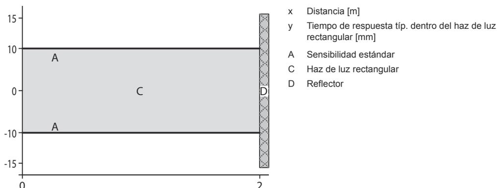
Objeto de referencia para la detección: Ø 5 mm con reflector TKS 100x100
