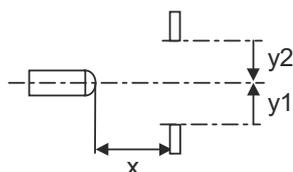
Comportamento di risposta tip. (distanza di regolazione 1300 mm)
