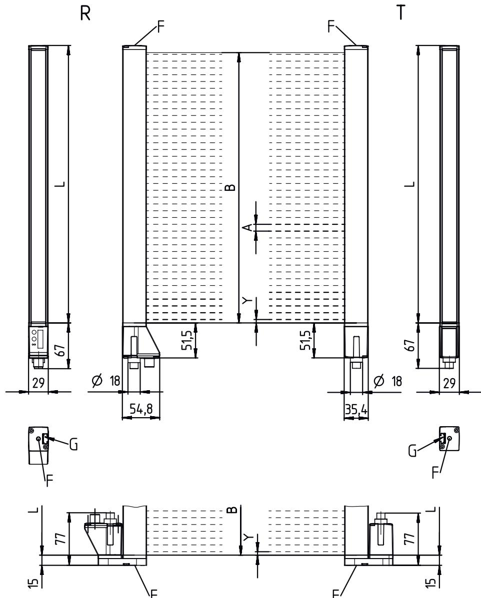
A Intervalle entre les faisceaux 20 mm
