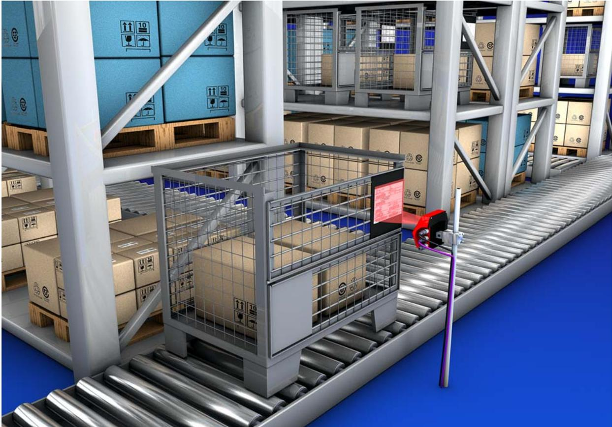
Figura 5.2: Principio de barrido del escáner lineal con suplemento de espejo oscilante
