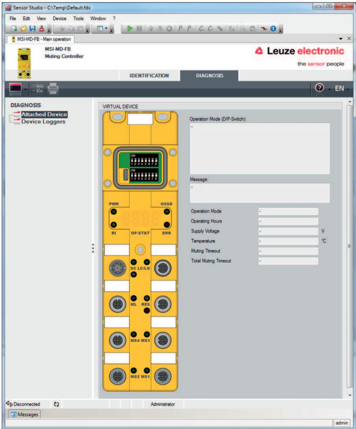
Fig. 12.4: Projet : gestionnaire d'appareils pour le contrôleur d'inhibition MSI-MD-FB
