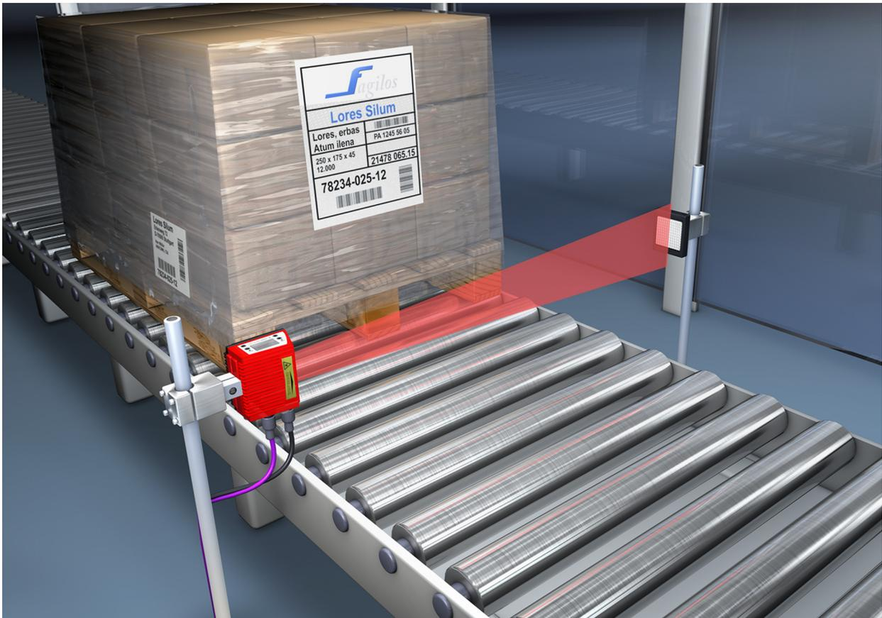
Bild 4.2: Reflektoranordnung für autoReflAct
