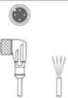
50130690 | KD U-M12-4W-V1-050 | Câble de raccordement | Application: Résistant aux produits chimiques<br>Connexion 1: Connecteur rond, M12, Coudé, Prise femelle, Codage A, 4 pôles<br>Connecteur rond, LED: Non<br>Connexion 2: Extrémité libre<br>Blindé: Non<br>Longueur de câble: 5.000 mm<br>Matériau de gaine: PVC |
