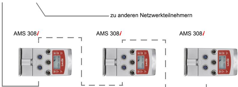
Bild 9.1: Ethernet – Linien-Topologie
