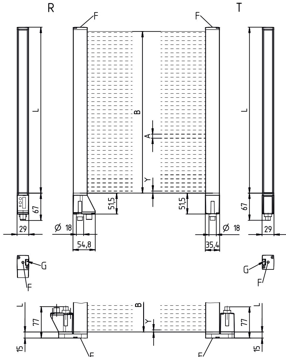
A Intervalle entre les faisceaux 10 mm
