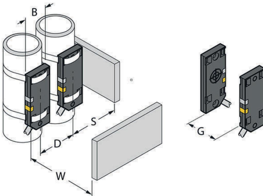
B Ø 20 mm, Durchmesser der aktiven Fläche      S 30 mm
