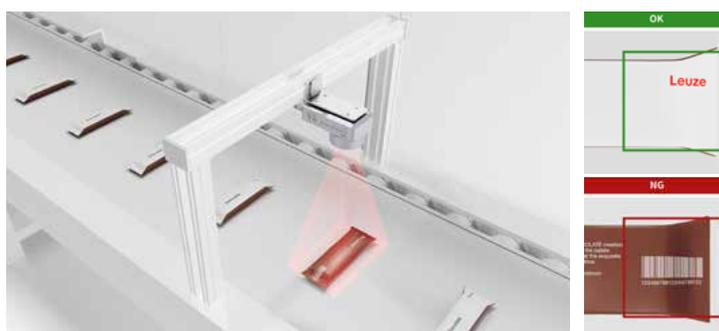
**Lösung:** Der DCR 1048i kann die Codes identifizieren, um zu prüfen, ob das Beutelprodukt richtig ausgerichtet ist oder nicht. Alternativ kann auch eine Mustererkennung verwendet werden, um die korrekte Ausrichtung der Beutelprodukte zu erkennen.
