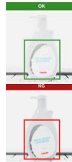
**Lösung:** Der neue IVS 1048i kann mit seinem variablen Sichtfeld und der großen Reichweite das Etikett leicht lokalisieren, messen und prüfen, ob es korrekt angebracht wurde oder nicht.
