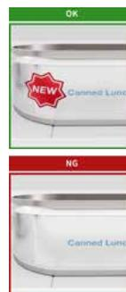
**Lösung:** Der IVS 108 ist hervorragend geeignet für die visuelle Nachkontrolle von Etiketten oder Direktmarkierungen auf Dosen. Gleichzeitig können die Bilder für eine spätere Analyse übertragen werden, falls dies erforderlich ist.
