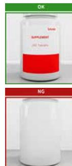
**Lösung:** Der IVS 108 kann die Anwesenheit hochtransparenter Etiketten zuverlässig auf jeder Oberfläche erkennen. Außerdem können die Bilder dieses Simple Vision Sensors zur Fehleranalyse oder für zukünftige Optimierungen übertragen werden.
