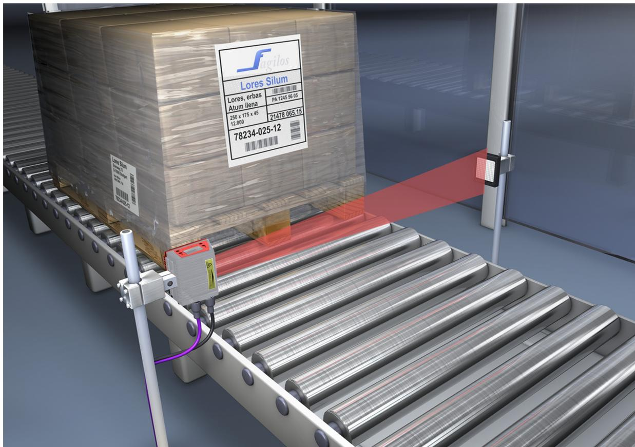
Bild 4.2: Reflektoranordnung für autoReflAct
