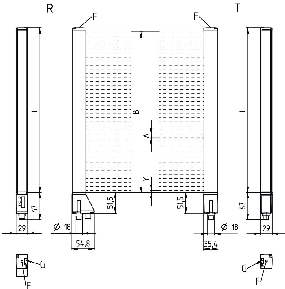
A 光束距离 5 mm      L 型材长度 1448 mm
