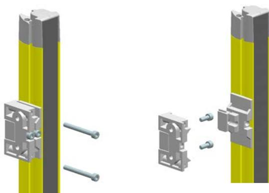
图 5.7: 使用旋转支架 BT-2SB05 和 M5 螺钉安装
