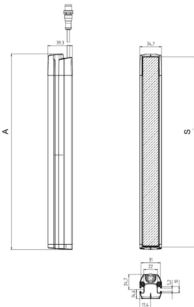
图 12.1: 发射器和接收器尺寸
