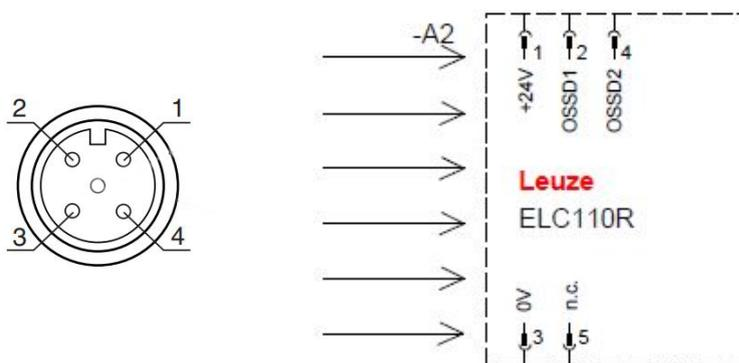
图 6.2: 接收器的插头分配和接线图
