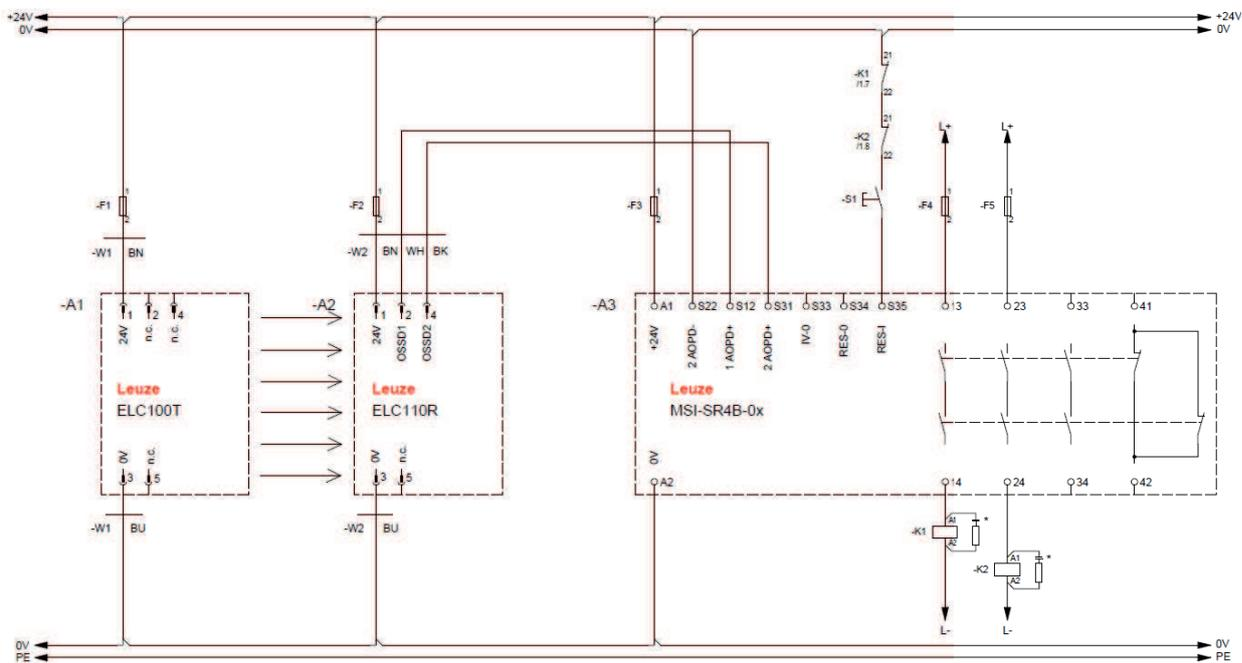
图 6.3: 带后置安全控制器MSI-SR4B的接线示例
