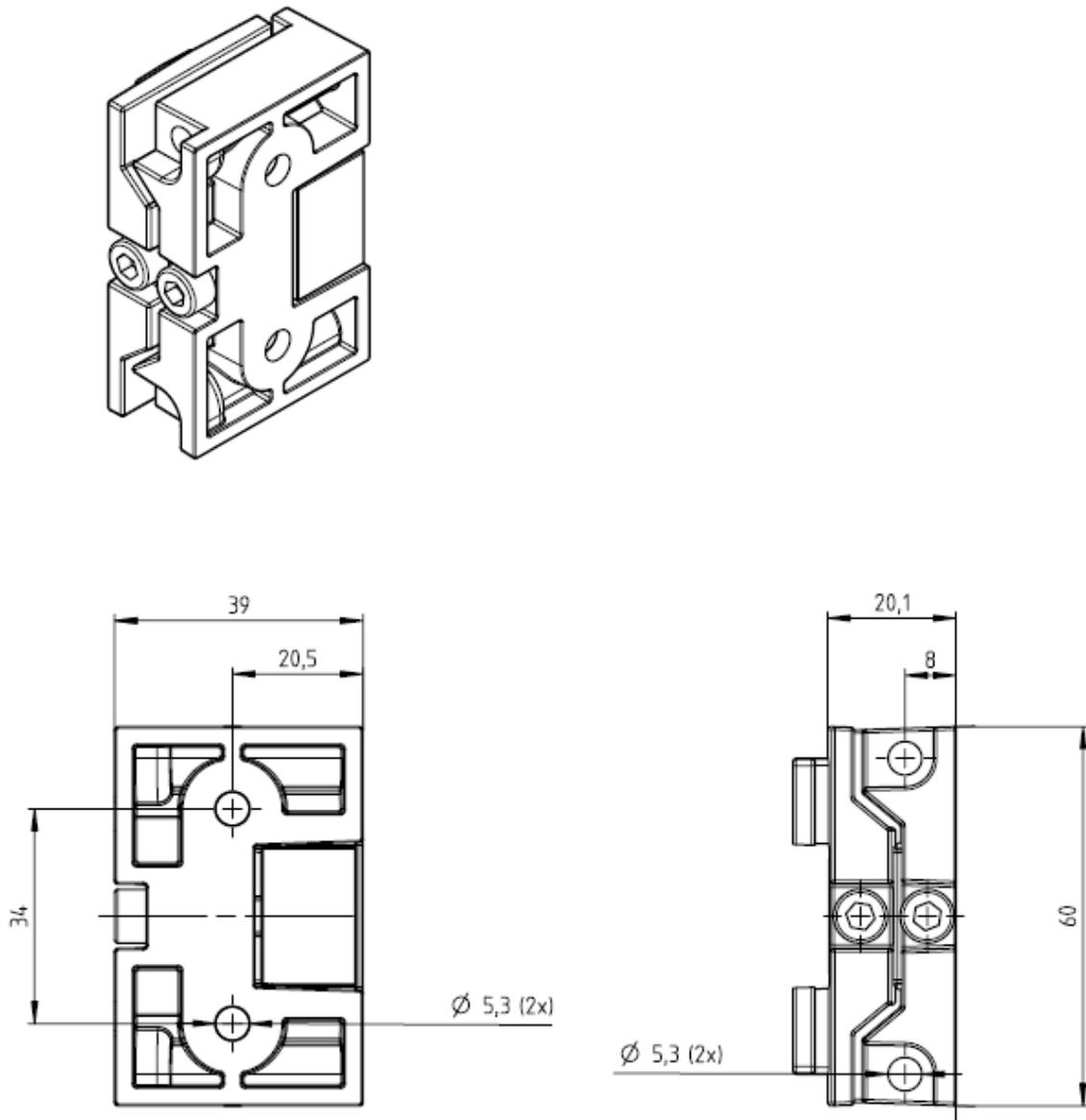
图 12.2: 用于凹槽安装的旋转支架 BT-SB05
