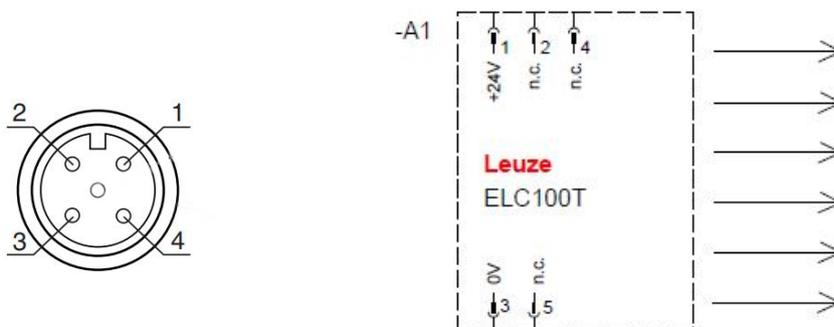
图 6.1: 发射器的插头分配和接线图
