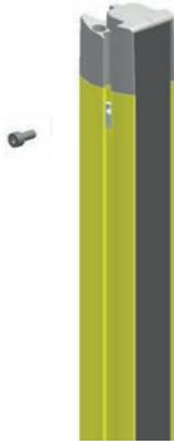
그림 5.6: 슬롯 너트 을 이용한 설치
