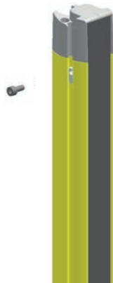
Figura 5.6: Montaje mediante tuercas correderas
