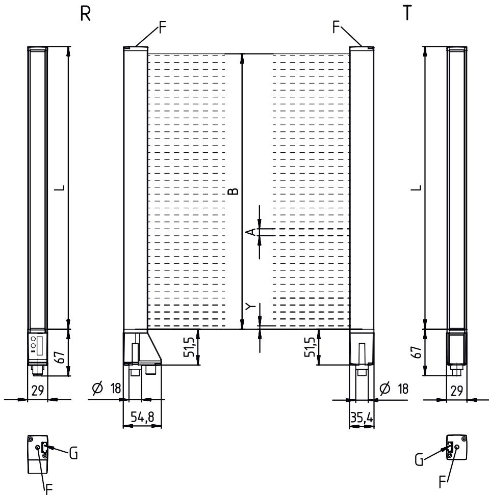
A 光束距离 5 mm      L 型材长度 1128 mm
