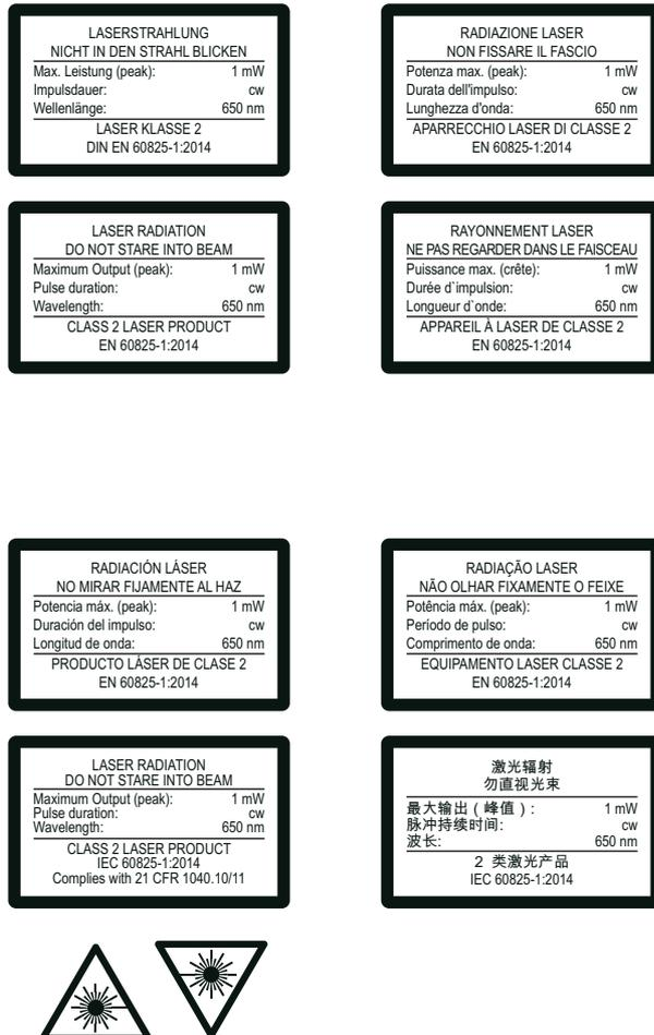
Bild 2.2: Laserwarn- und Laserhinweisschilder – beigelegte Aufkleber
