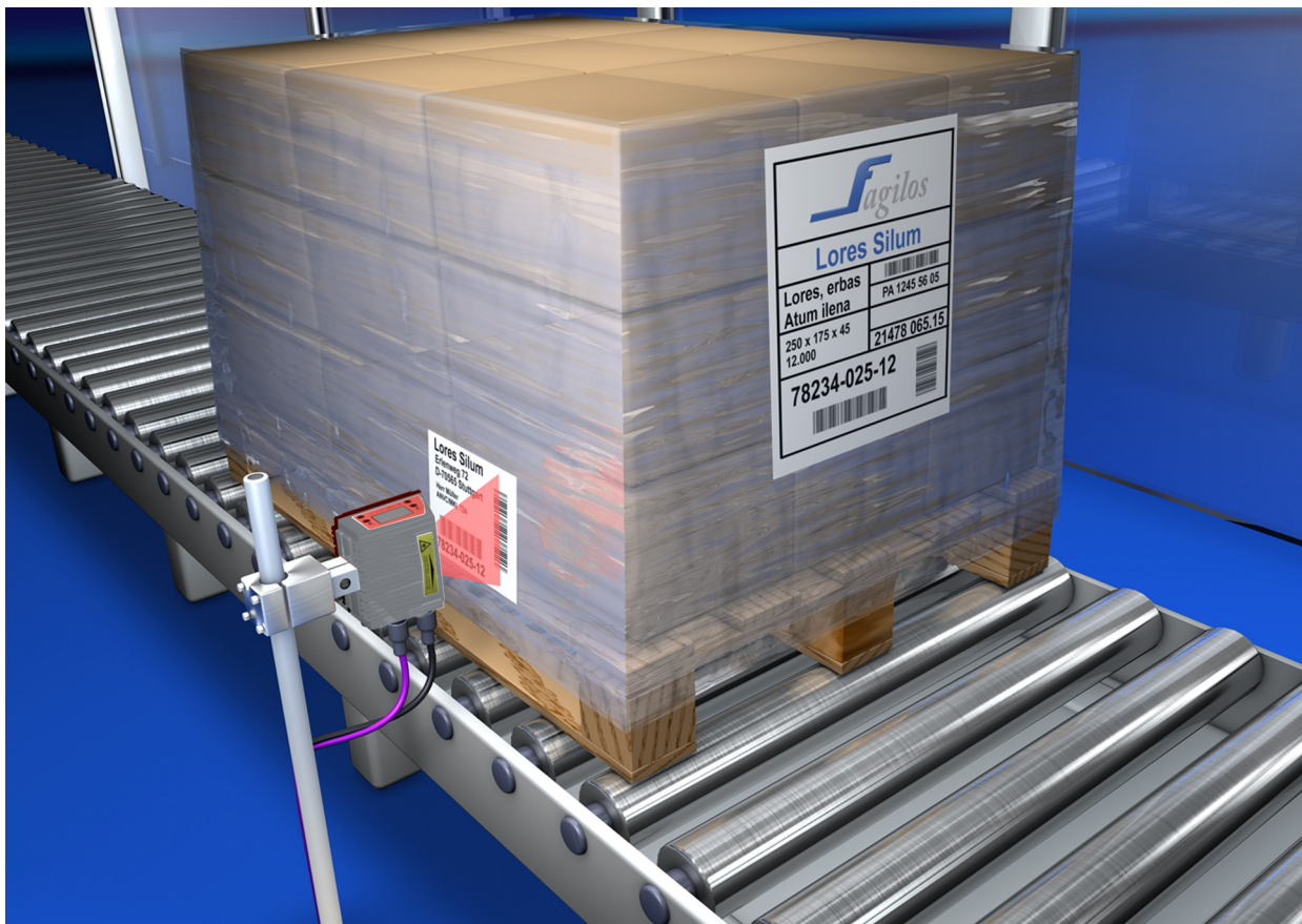
Bild 5.1: Ablenkprinzip für den Linienscanner
