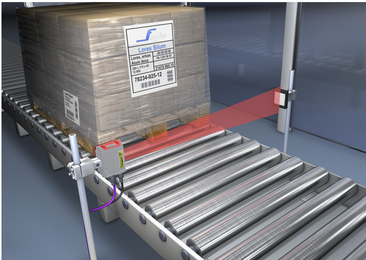
Bild 4.2: Reflektoranordnung für autoReflAct
