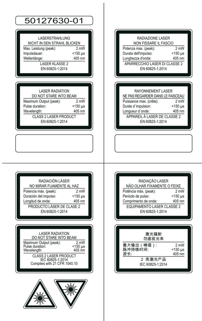
Figura 2.3: Segnali di pericolo e targhette di avvertimento laser – Etichette in dotazione
