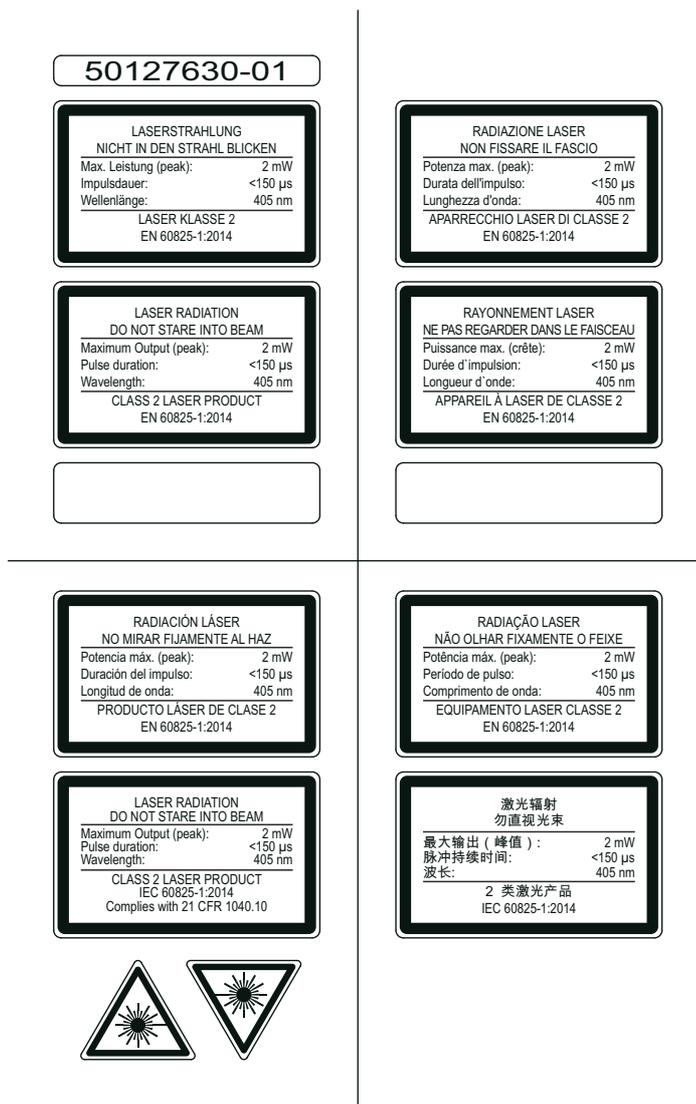
Fig. 2.3: Placas de advertencia láser – etiquetas adhesivas incluidas
