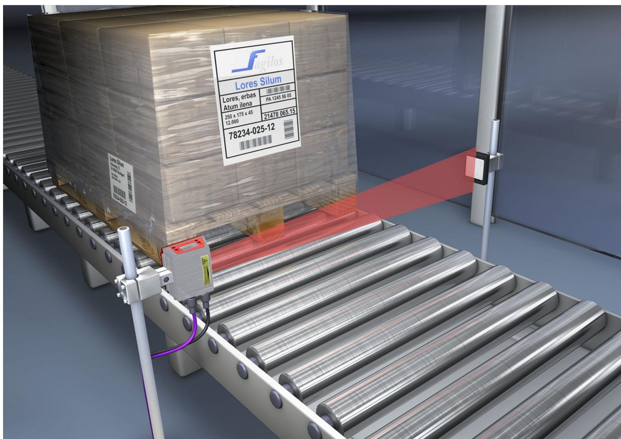
Figura 4.2: Disposizione del riflettore per autoReflAct
