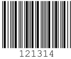
Figura 17.7: Tipo di codice 11: Codabar
