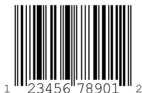
Figura 17.3: Tipo di codice 06: UPC-A
