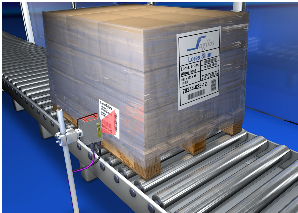
Fig. 5.1: Principio de barrido del escáner lineal
