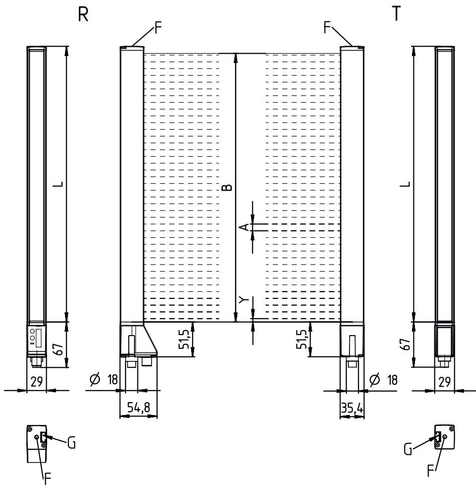
A 光束距离 10 mm      L 型材长度 1048 mm
