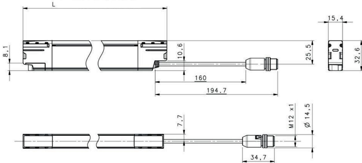
L 结构长度/保护区高度
