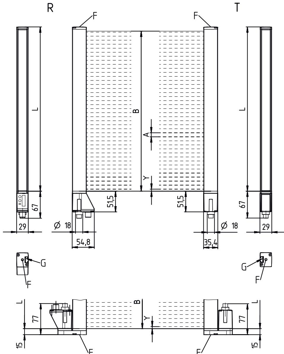
A Intervalle entre les faisceaux 5 mm
