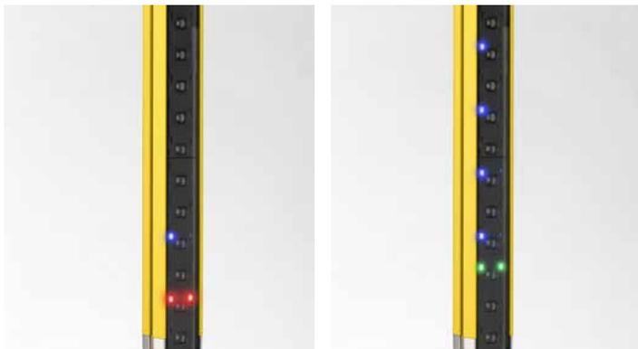
Mit der Multi-Level-Ausricht-Anzeige ist die Inbetriebnahme der Geräte besonders einfach. Bereits eine grobe Ausrichtung wird zuverlässig angezeigt. Durch die gut sichtbaren, leuchtstarken LEDs kann das Ergebnis der Ausrichtung direkt vom Sender aus beobachtet werden. So ist die optimale Einstellung schnell erreicht. Dies spart Zeit und Geld bei der Inbetriebnahme und bietet Reserven im Betrieb.
