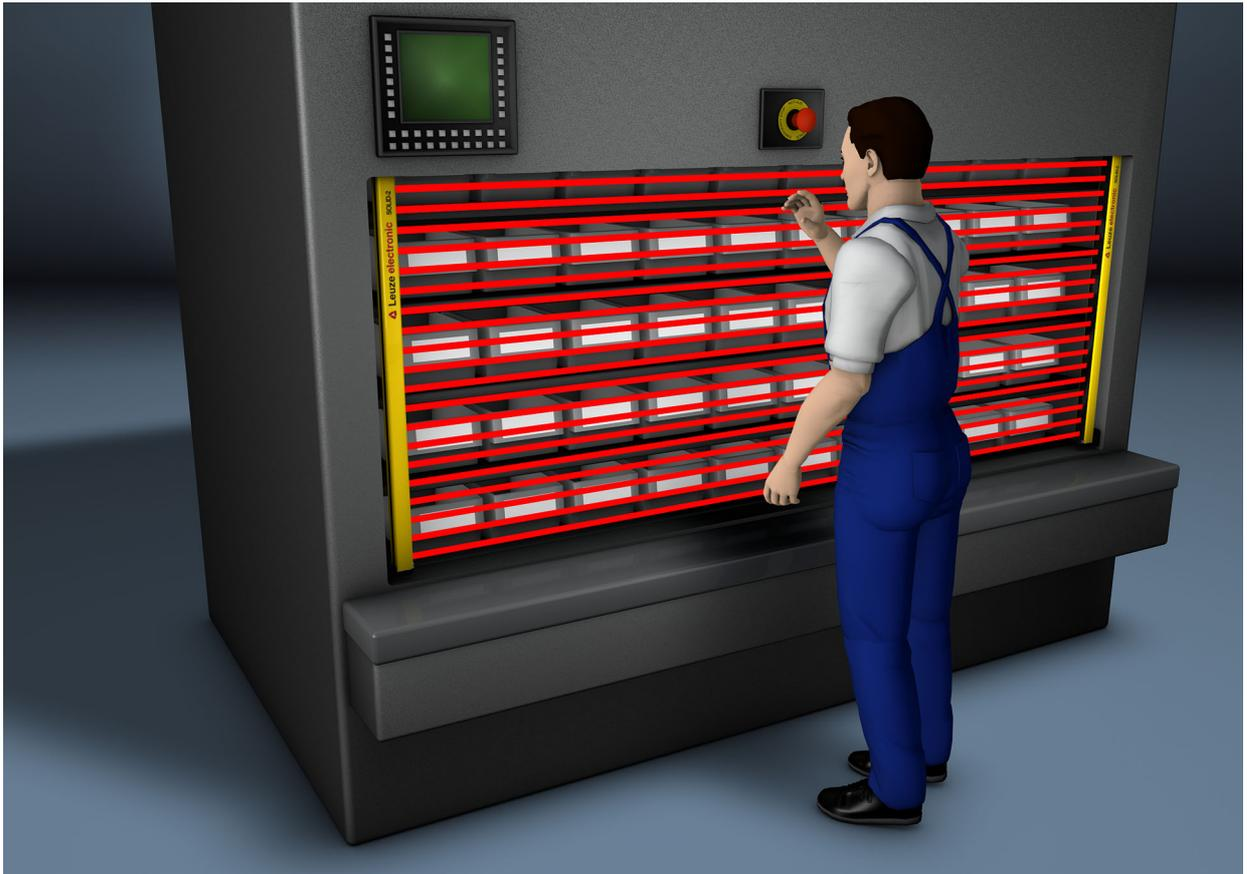
图 5.1: 通过 MLC 安全光幕和 MSI-RM2B 继电器模块对一个货架自动仓储机进行防护
