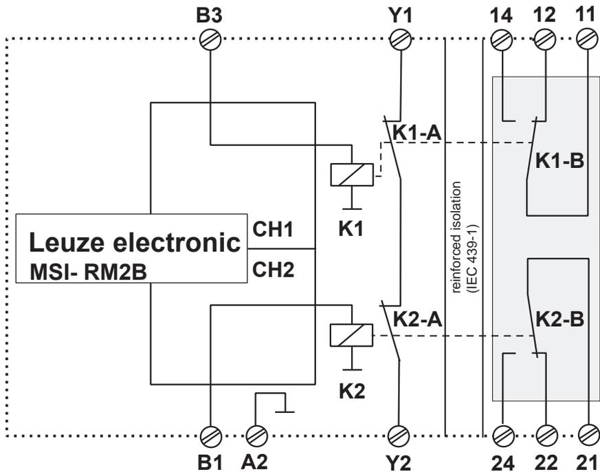
图 3.3: MSI-RM2B 的内部原理图
