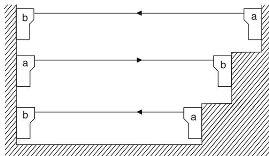
Рис. 6.1: Многоосевое расположение с геометрическим смещением (макс. 15 м)
