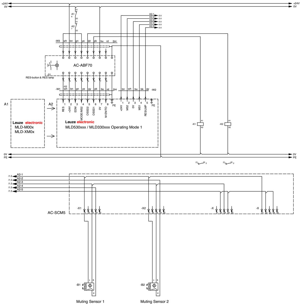
Рис. 7.11: Пример подключения системы приемопередатчика MLD 330, MLD 530: подавление с 2 датчиками с управлением по времени с выдержкой времени подавления 10 минут
