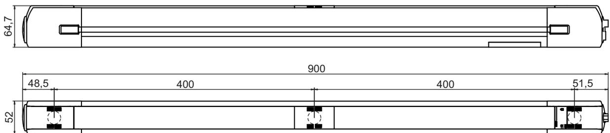
Рис. 14.6: Размеры MLD, 3-лучевой приемопередатчик
