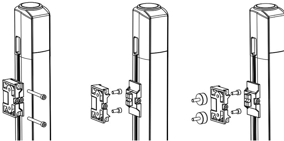
Рис. 6.16: Зажимной поворотный держатель BT-2SB10
