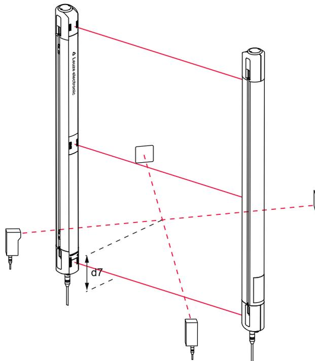
Рис. 6.9: Расположение датчиков подавления на высоте d7
