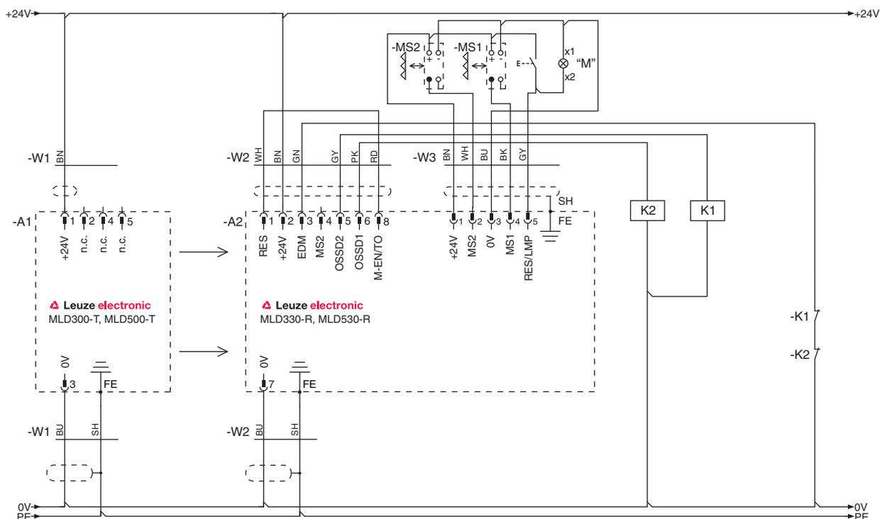
Рис. 7.13: Пример подключения MLD 330, MLD 530 (система передачи и приема): подавление с 2 датчиками с управлением по времени с выдержкой времени подавления 100 часов (приемопередатчик подключается аналогично)
