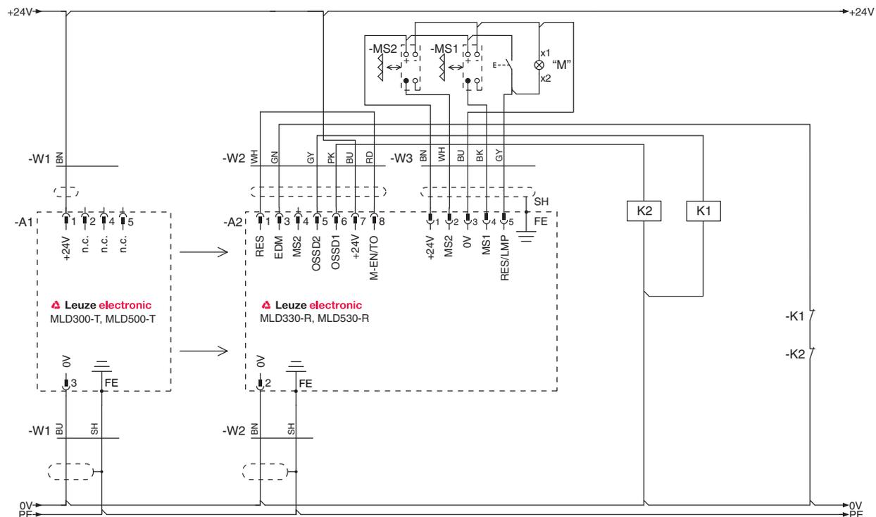
Рис. 7.15: Пример подключения MLD 330, MLD 530 (система передачи и приема): последовательное подавление с 2 датчиками (приемопередатчик подключается аналогично)
