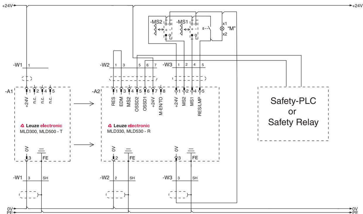
Рис. 7.18: Пример подключения MLD 330, MLD 530 (система передачи и приема): частичное подавление (приемопередатчик подключается аналогично)
