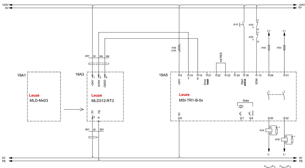
Рис. 7.10: Пример подключения MLD 312 (система передачи и приема) и MSI-TR1B-0x, с EDM и RES
