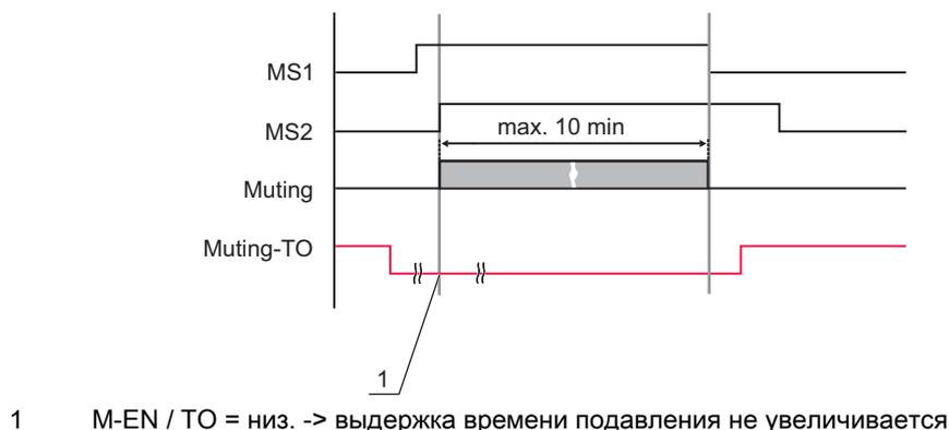
Рис. 4.7: Отсутствует сигнал увеличения выдержки времени подавления
