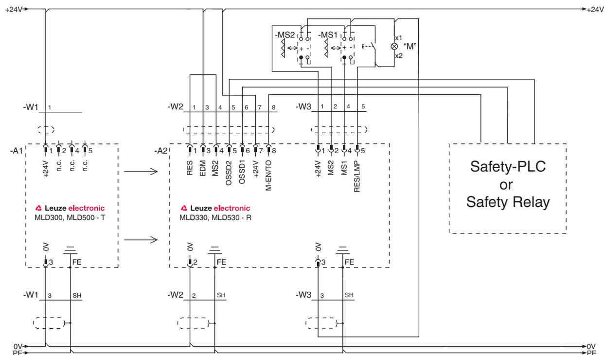
Рис. 7.17: Пример подключения MLD 330, MLD 530 (система передачи и приема): разрешение на включение подавления (приемопередатчик подключается аналогично)
