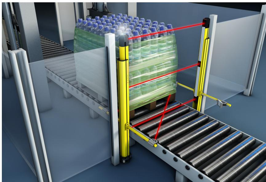
Рис. 5.3: Защита доступа к обмотчику поддонов с применением подавления с 2 датчиками с управлением по времени
