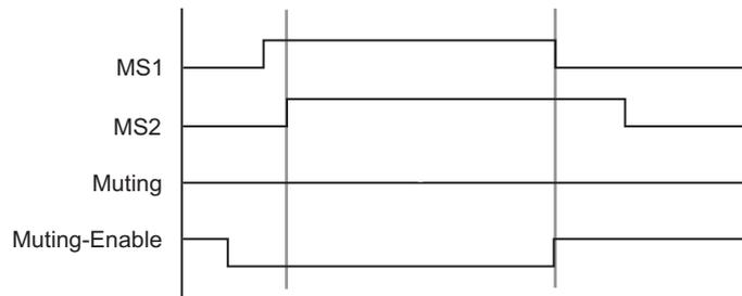
Рис. 4.10: Отсутствует сигнал разрешения на включение подавления
