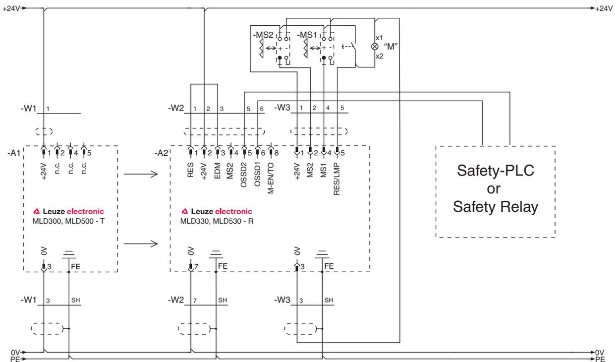
Рис. 7.16: Пример подключения MLD 330, MLD 530 (система передачи и приема): последовательное подавление с 2 датчиками с выдержкой времени подавления 100 часов (приемопередатчик подключается аналогично)
