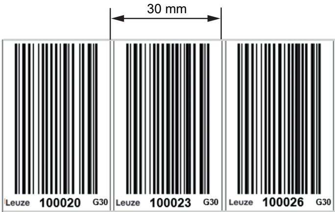
图 9.12: 检查自行打印的在线维修用条码带上的 30 mm 尺寸
