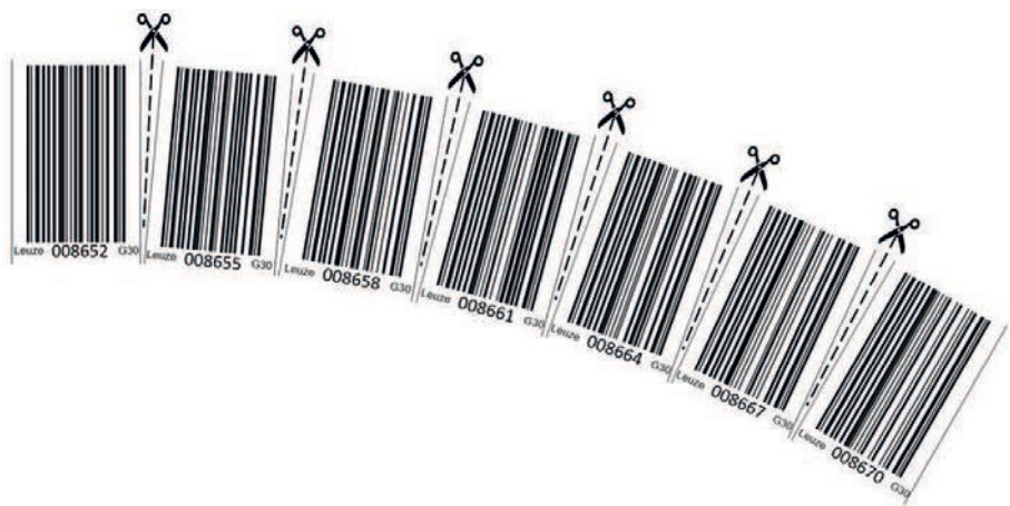
图 9.10: 垂直曲线内的条码带加工
