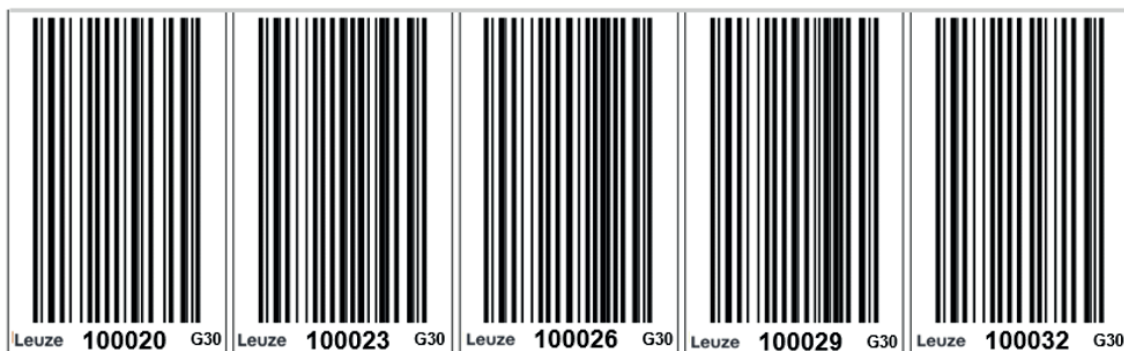
Fig. 9.1: Fita de códigos de barras, começando com o valor de posição 1000,20 m e continuando com valores crescentes em 3 cm / 30 mm
