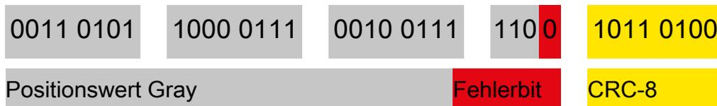
\* Seule la valeur de position à codage gray est transmise. Le bit d'erreur et le CRC-8 restent en représentation binaire.
