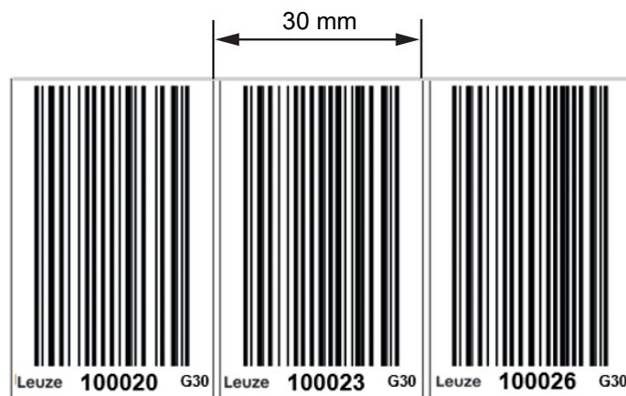
Fig. 9.12: Vérification des 30 mm sur l'impression de la bande à codes à barres de réparation en ligne
