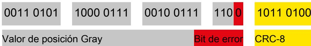
\* Solo se transmite el valor de posición con codificación Gray. Tanto el bit de error como el bit CRC-8 permanecen en representación binaria.
