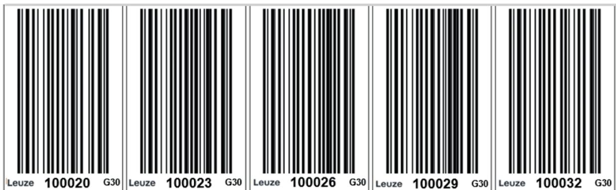
Figura 3.2: Cinta de códigos de barras, que comienza con un valor de posición de 1000,20 m, durante el avance va subiendo en 3 cm
