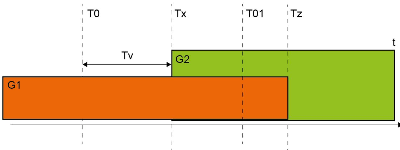
Figura 5.13: Conmutación entre campos de protección en 2 puntos de peligro
