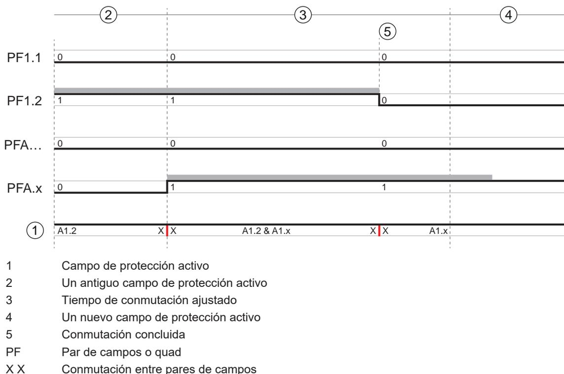
Figura 5.3: Diagrama de tiempos y señales: supervisión solapada
