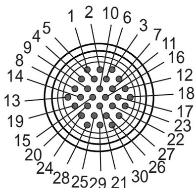
Figura 8.1: Asignación de pines de conector M30, de 30 polos
