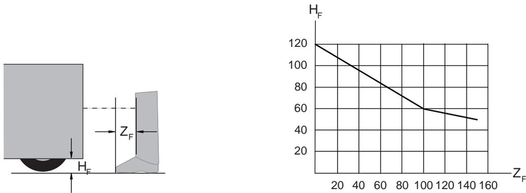
Figura 7.15: Diagrama para la determinación del suplemento  $Z_F$  cuando no hay suficiente altura sobre el suelo  $H_F$ . Cuando las ruedas están montadas cerca de la pared lateral, añada en cada caso un suplemento  $Z_F > 150$  mm.
