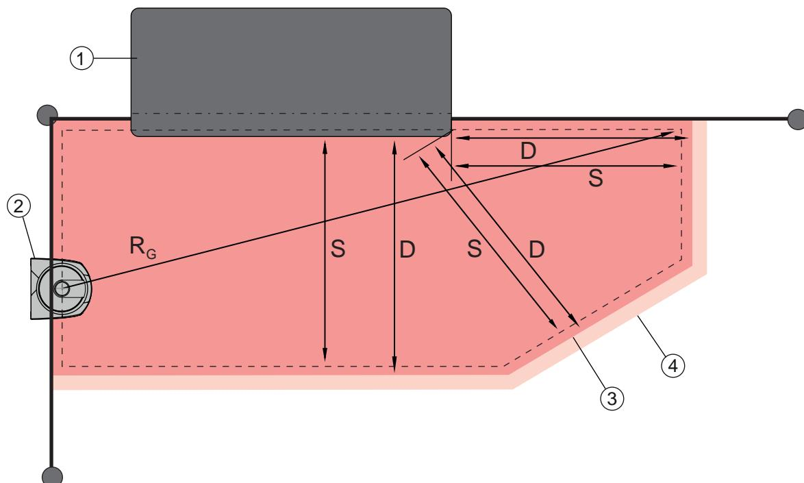
1 上铣刀（有足够的空间确保传感器保护区域能覆盖机器工作台的下方）
