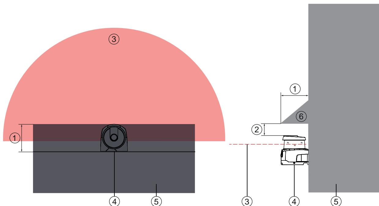
图 7.7: 通过与机器轮廓重叠部分进行尾部防护
