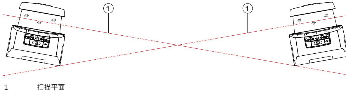
图 7.10: 并排安装 (无高度偏差·带角度偏差)
