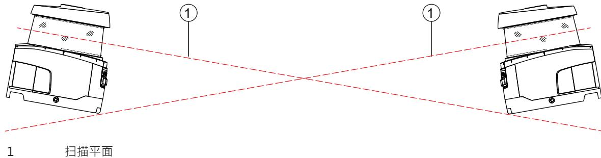
图 7.11: 相对安装 (无高度偏差·带角度偏差)
