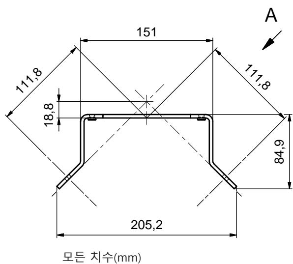
그림 15.10: 설치 브래킷 BT840M
