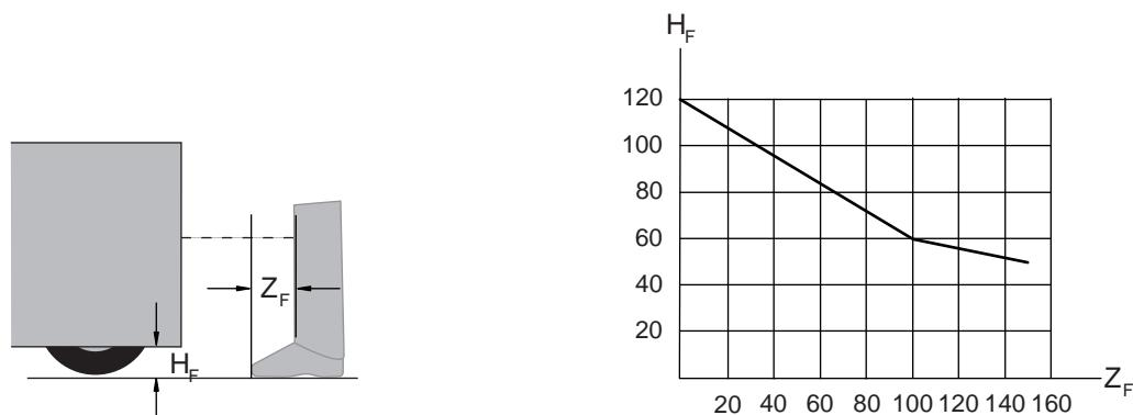
그림 7.15: 바닥의 빈 공간  $H_F$ 가 부족할 때 여유한계  $H_F$ 를 결정하기 위한 도표
