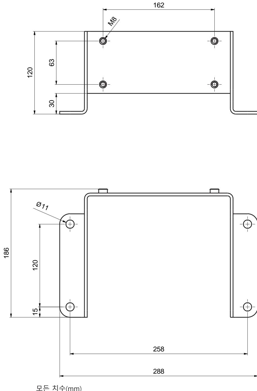
그림 15.7: BTF815M 설치 각도
