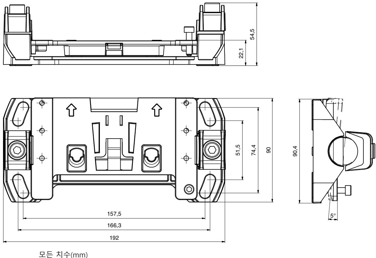
그림 15.6: 설치 시스템 BTU800M
