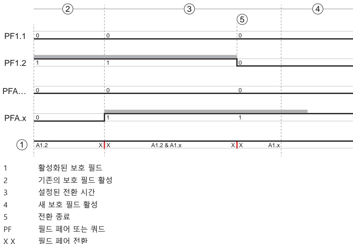
그림 5.3: 신호-시간 다이어그램: 오버랩 모니터링
