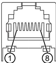
图 8.9: 引线布局 PROFINET RJ45 AIDA-Push/Pull
