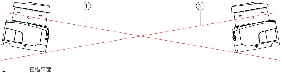
图 7.12: 相对安装 (无高度偏差·带角度偏差)
