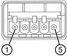
图 8.8: 引线布局 PROFINET AIDA Push/Pull · 5 针
