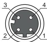
图 8.3: 引线布局 M12 插口 · 4 针 · D 编码
