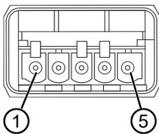
图 8.11: 引线布局 PROFINET AIDA Push/Pull · 5 针
