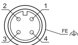
图 8.2: 引线布局 M12 插口 · 4 针 · A 编码
