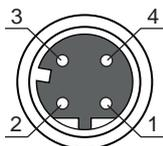
图 8.6: 引线布局 M12 插口 · 4 针 · D 编码
