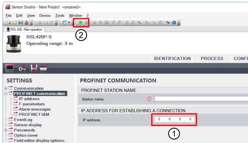
그림 4.4: 장치 관리자(DTM) - IP 주소
