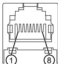
그림 8.9: PROFINET RJ45 AIDA Push/Pull 연결부 할당
