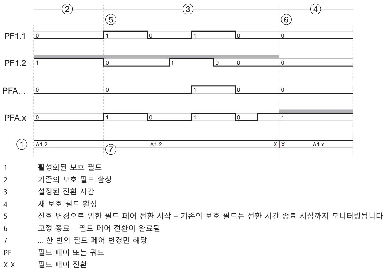
그림 5.2: 신호-시간 다이어그램: 오버랩 모니터링
