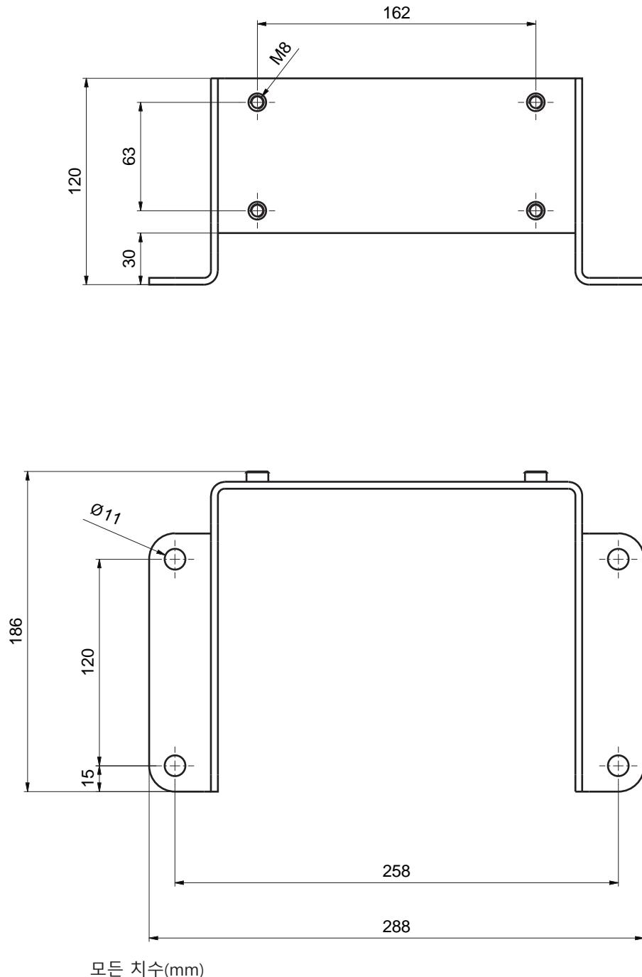
그림 16.6: BTF815M 설치 각도
