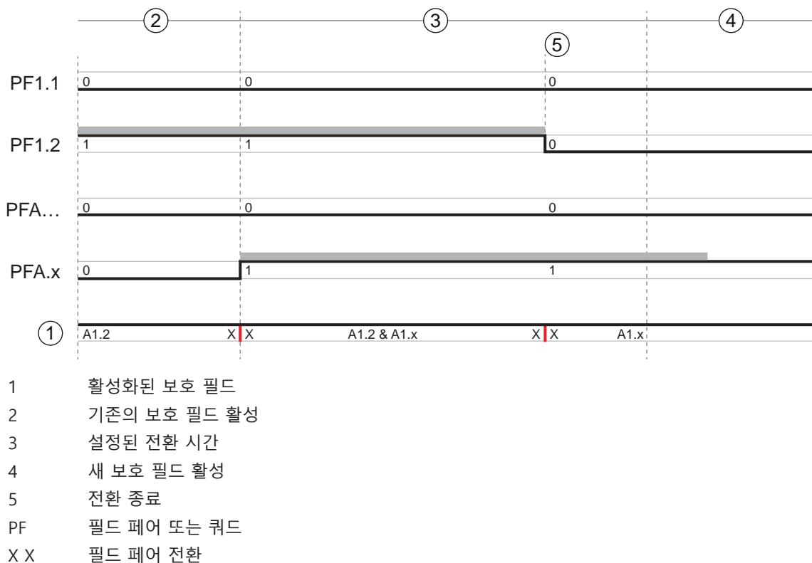
그림 5.1: 신호-시간 다이어그램: 오버랩 모니터링
