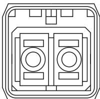
그림 8.12: PROFINET SCRJ Push/Pull AIDA 연결부
