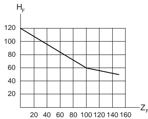
그림 7.16: 바닥의 빈 공간  $H_F$ 가 부족할 때 여유한계  $H_F$ 를 결정하기 위한 도표
