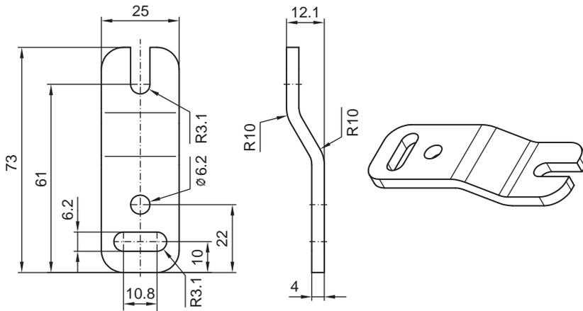
그림 14.3: 병렬 고정 장치 BT-Z
