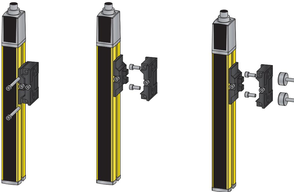
Figura 6.9: Montaje a través de soporte orientable BT-2SB10
