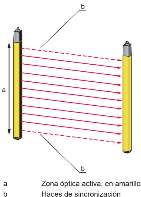
Figura 3.1: Sistema emisor-receptor
